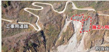
別当谷の斜面崩壊を防ぎ、大規模な土砂流出を予防します。また、登山道（砂防新道）ならびに砂防工事用道路を守ります。
