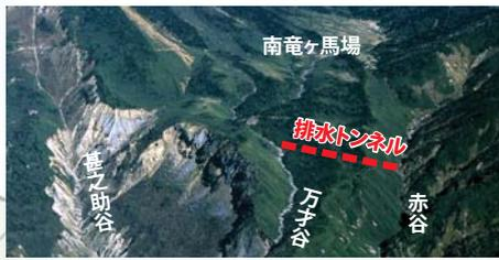
甚之助谷・左岸大規模ブロックへの万才谷周辺からの地下水の流入を抑制するため、万才谷周辺から赤谷へ向けて排水トンネルの施工を実施します。
