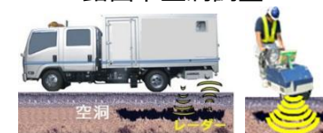
路面下空洞調査
