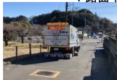
(空洞探査車による調査)
