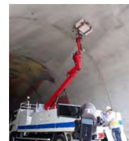
レーザー打音による変状の把握
