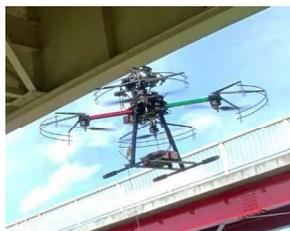
▲橋梁の損傷写真を撮影する技術
