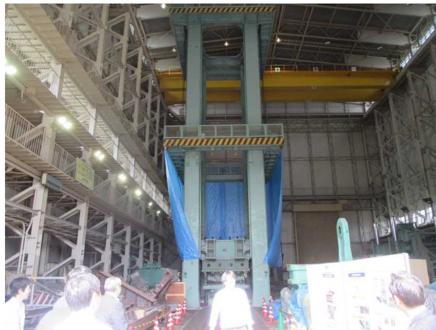
土木研究所の300N(3000T) 載荷試験機
