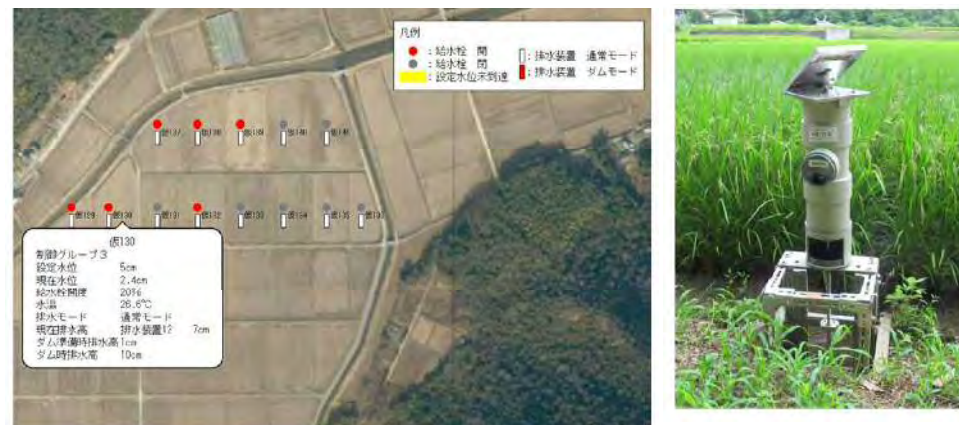
田面水位の調整を自動化し、適切なタイミングで排水する。
