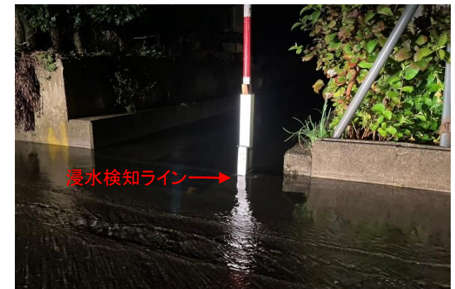
浸水検知ラインを超過した場合、システムに表示される仕組み。
