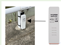
ワンコイン浸水センサ(小松市)
