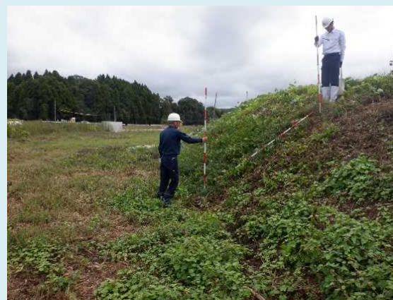
目的別巡視(堤防等点検)
