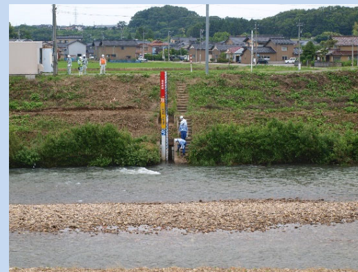
埴田水位観測所点検状況
