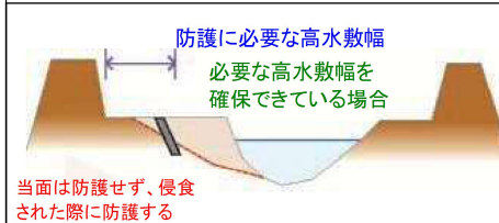
梯川における堤防防護の考え方（河川整備計画より）（図2-8）
