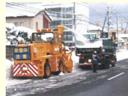
運搬排雪作業状況
