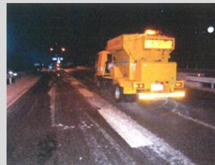
凍結防止剤散布状況
