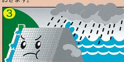
大雨でダムに流れてくる水の量が増えた時には、下流に一度に流さないようにダムに貯めながら水を流し、少しずつ増やします。
