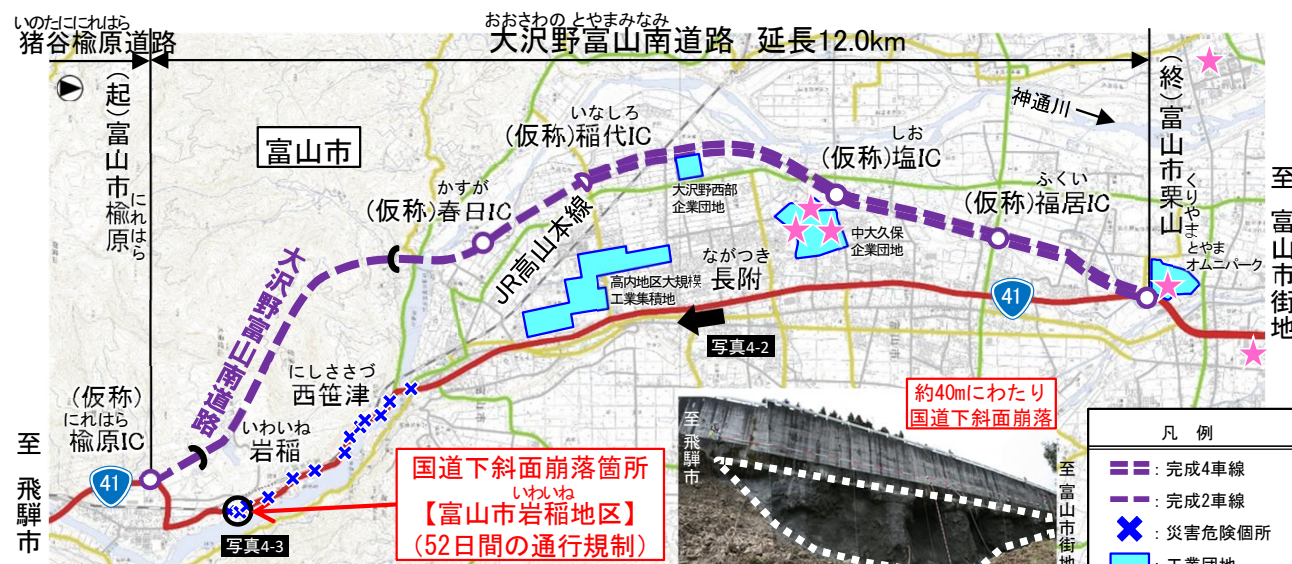
写真4-3 岩稲地区の国道下斜面崩落 (H22.3.9)
