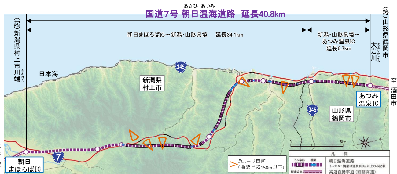
図4-7 並行する国道7号現道の曲線半径
