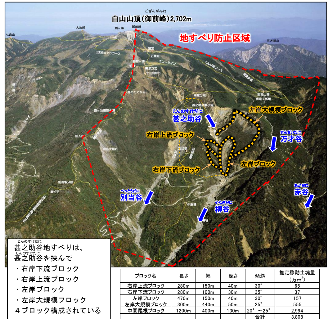
図1-2：地すべりブロックの諸元
