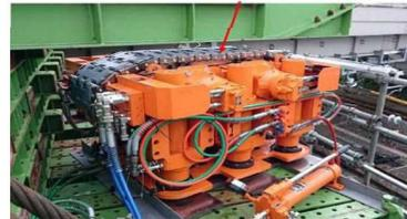
支点部での抵抗なく送り出しを行うための装置。駆動式のため、通常のローラーよりも送り出しに対する抵抗が少ない。
