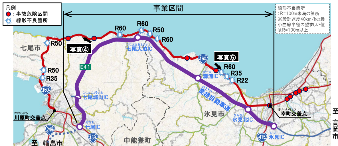
図2-5 国道160号の線形不良・事故危険区間
