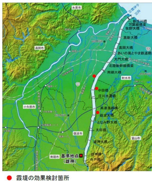
図 4.2.24 庄川における霞堤の現状
