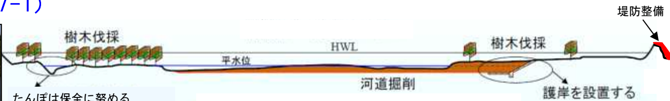
河道掘削・堤防整備イメージ
