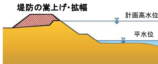
堤防整備（築堤）のイメージ
