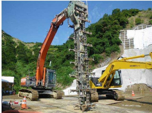
施工機械(トレンチャー式攪拌機)
