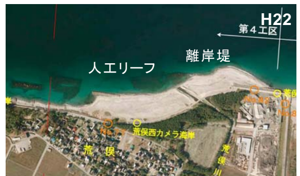
離岸堤及び人工リーフによる海浜の回復状況（荒俣）
