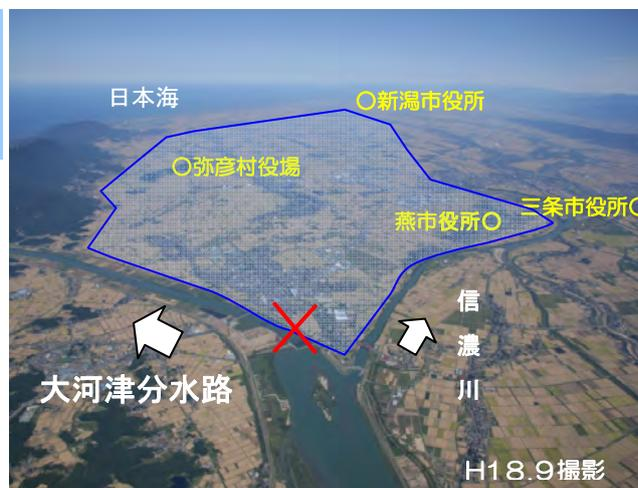
可動堰右岸0.2kp破堤時の想定浸水範囲
