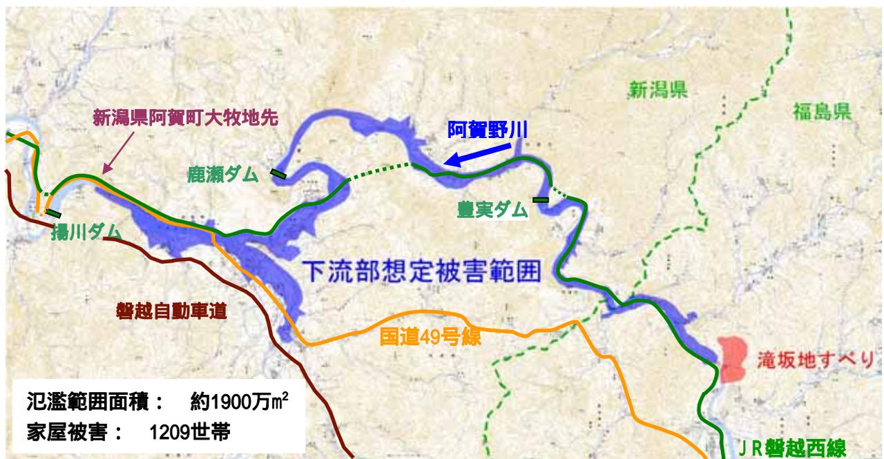
図7-3 河道閉塞決壊時の想定被害範囲図（下流部氾濫域）
