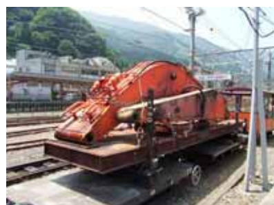
唯一の輸送手段である黒部峡谷鉄道による機材・資材等の輸送（分解輸送）
