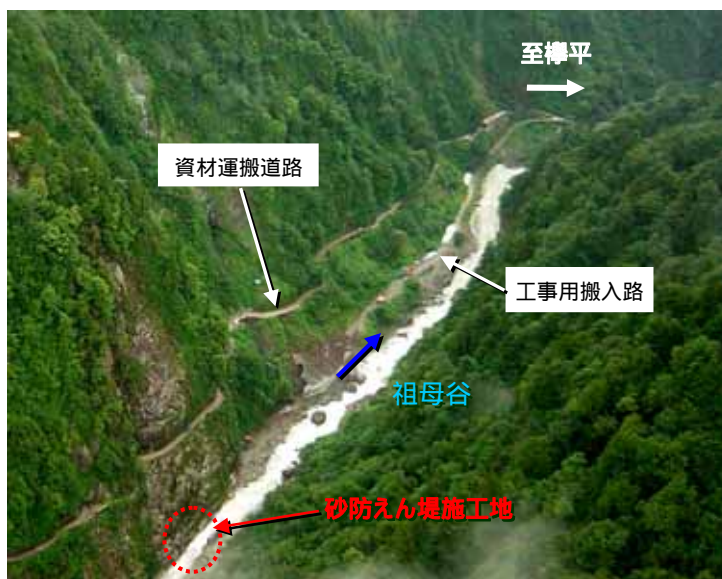
急峻な地形に整備された、資材搬入のための工事用道路 （祖母谷）
