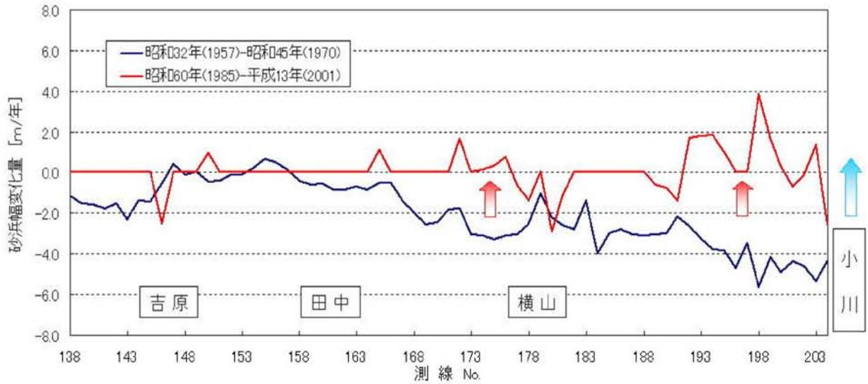
第二・三工区(入善町)の砂浜幅及び砂浜幅変化量図
