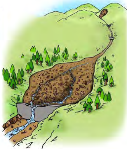
② 大雨と一緒に大量の土砂が流れてくると、川の勾配がゆるい堰堤の上流側で水のスピードが遅くなり、既にたっていた土砂の上にさらに大きく一部の土砂が積もってたまります。
