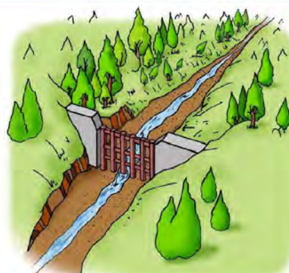
② 透過型砂防堰堤を設けた場合でも、普段は、水と土砂は同じように下流に流れていきます。
