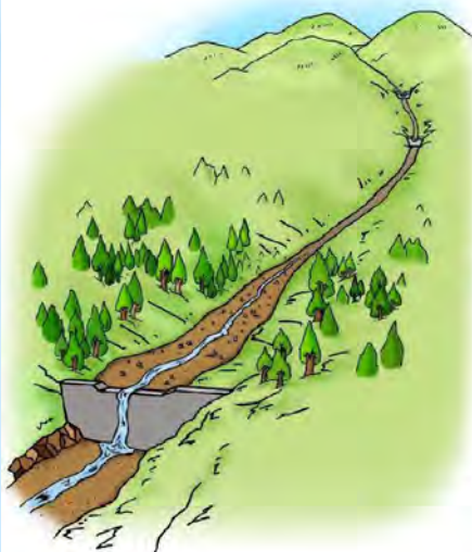
① 不透過型砂防堰堤は、土砂で一杯になっていても、効果がなくなるわけではありません。堰堤の上流側では、土砂がたまって川の勾配がゆるくなり、川幅も広がるため、水が流れるスピードも遅くなります。
