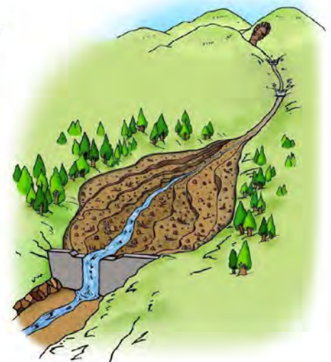
③ 上にたまった土砂はその後、雨が降るたびに水の力で削られ、少しずつ下流に流れ出ていきます。(その後、大雨が降ると再び②のように大きく積もってたまります。)
