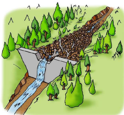
③ 大雨が降り土石流が発生したとき、堰堤は大きな岩や流木などを含む土砂をため、下流への被害を防ぎます。
