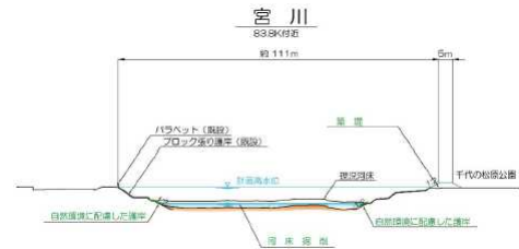
図-3.3 (1) 宮川及び支川計画横断面イメージ図 断面形状は、必要に応じて変更することがあります。
