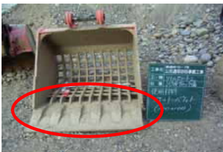
鉄板設置後(スケルトンバケット)
