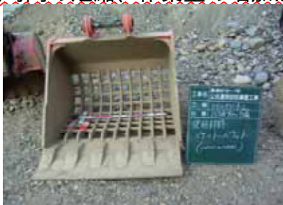
スケルトンバケット編目 100mm × 100mm
