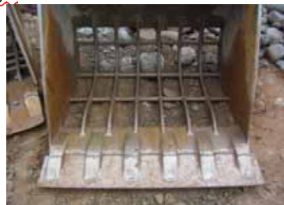
スケルトンバケット編目 150mm × 200mm
