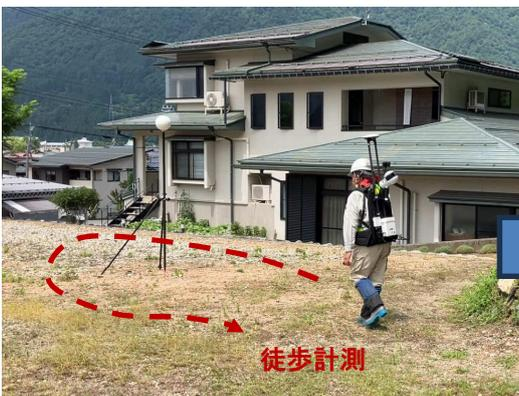
■ バックパック型レーザ計測状況
