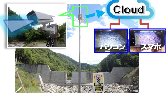
【写真-7 現場場内に設置したカメラ】
