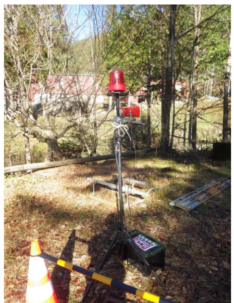
土石流センサー等の設置状況（上：外ヶ谷地区、下：岩坪谷地区）
