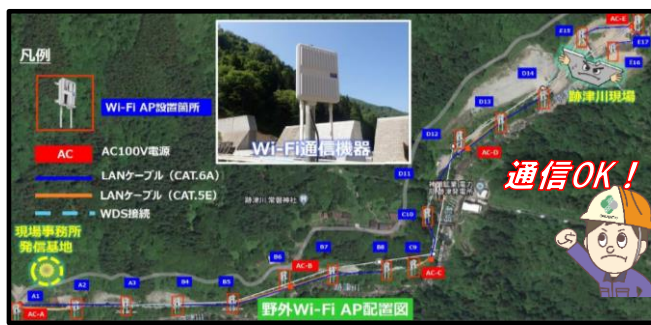
【図-5 野外Wi-Fi配置図】
