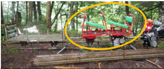
乗用台車を取り付けたモノレールの様子。搭乗定員は2名で、台車には転落防止帯が取り付けられている。
