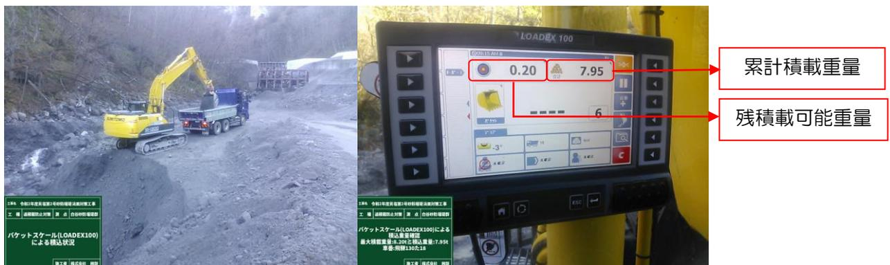
このシステムを導入したことで、従来の積込回数管理では不確かであった正確な積載重量の管理が可能になり、確実な過積載防止対策ができた。また、「積載量の見える化」によって、積込回数の間違い等のヒューマンエラーの防止にも繋がった。
