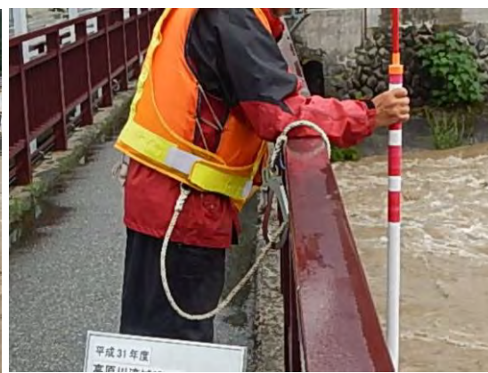
安全帯の使用 (拡大写真)
