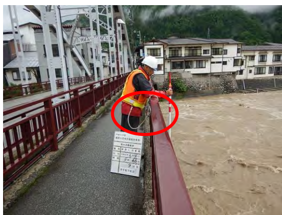
浮子投下員作業状況
