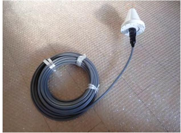
【写真6 GPSアンテナ端末処理完了】
