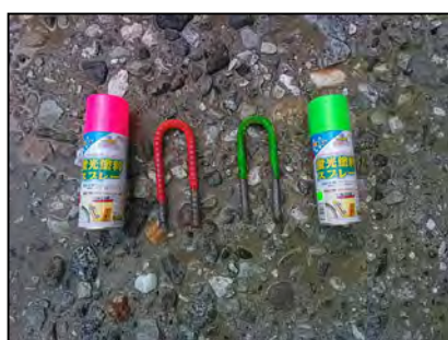
差し筋着色【写真-5】
