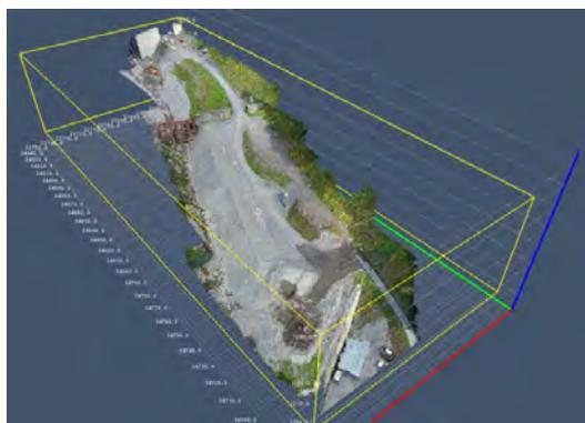
【起工測量 3次元測量データ】
