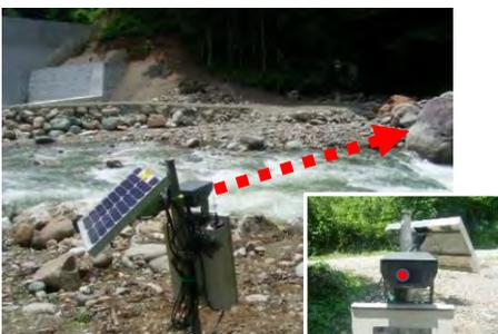
・写真-4 川に設置した赤外線センサー
