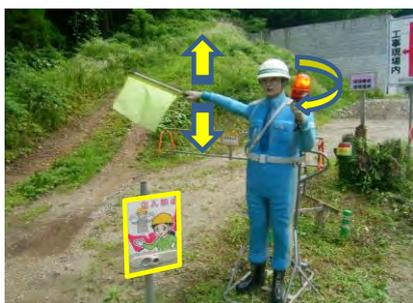
・写真-2 管理用道路に設置したガードマンロボットと人感センサー
