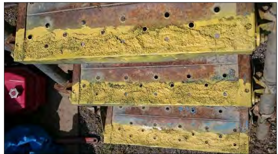
昇降部にペンキを塗り『砂』をまく。 乾くとすべり止め効果を発揮。
