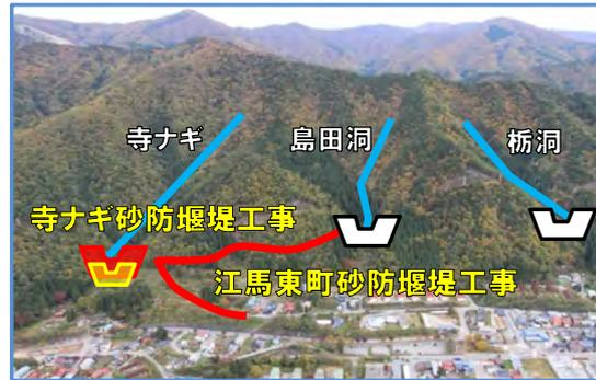
・図-3 寺ナギ砂防堰堤工事と他工事との関連
