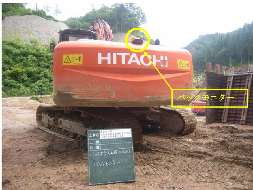
写真1 バックホウにバックモニターを装着
