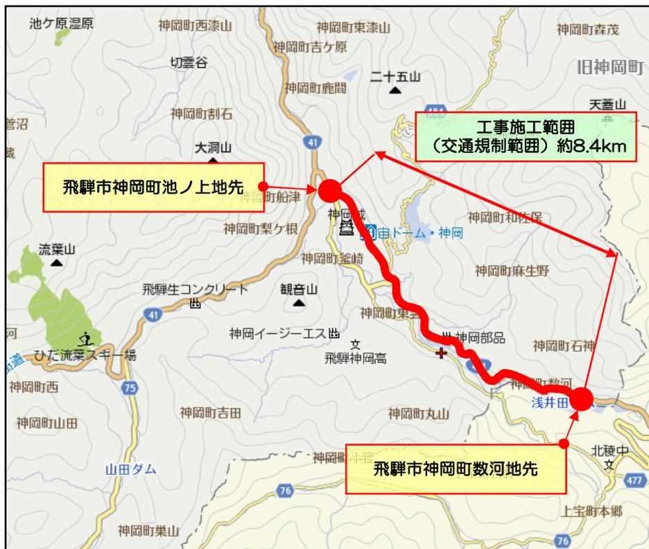
工 種: 光管路配管工 配管工 L=3140m、ハンドホール工 N=14箇所
