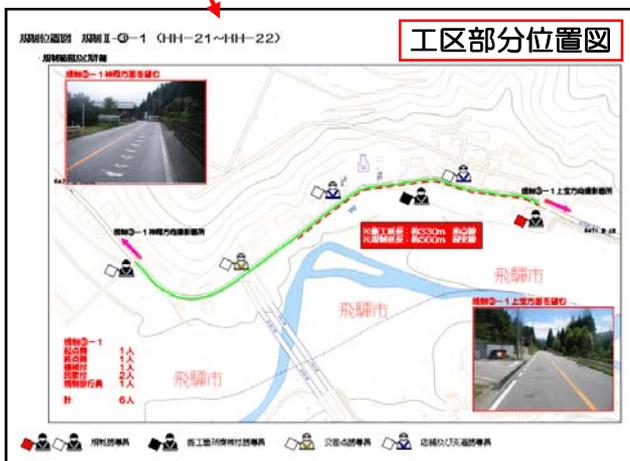
※各工区内それぞれに安全と思われる規制位置を決め、位置図兼配置図を作成し、規制当日の指示や工事教育に活用した。(規制の型全て)
