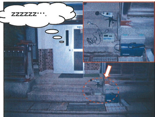
住居前で振動計と騒音計による計測
