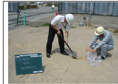
六価クロム溶出試験による土壌調査(判定:基準値以下) ⑩
