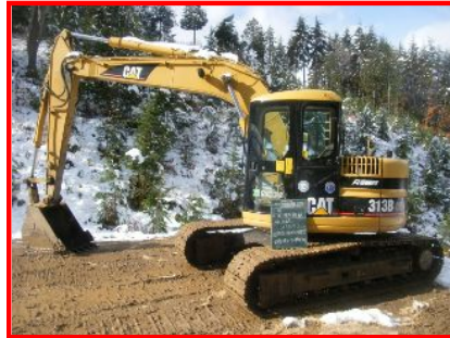
【取付機械 BH0.45m³】
