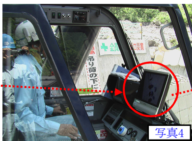
〔200tクレーンに高感度CCDカメラ・モニター取付〕
