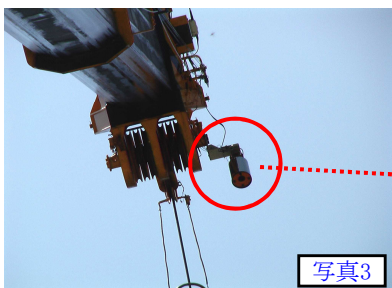
〔200tクレーンに高感度CCDカメラ・モニター取付〕
