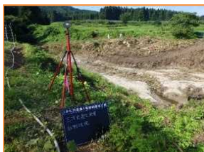
3次元測量実施状況
